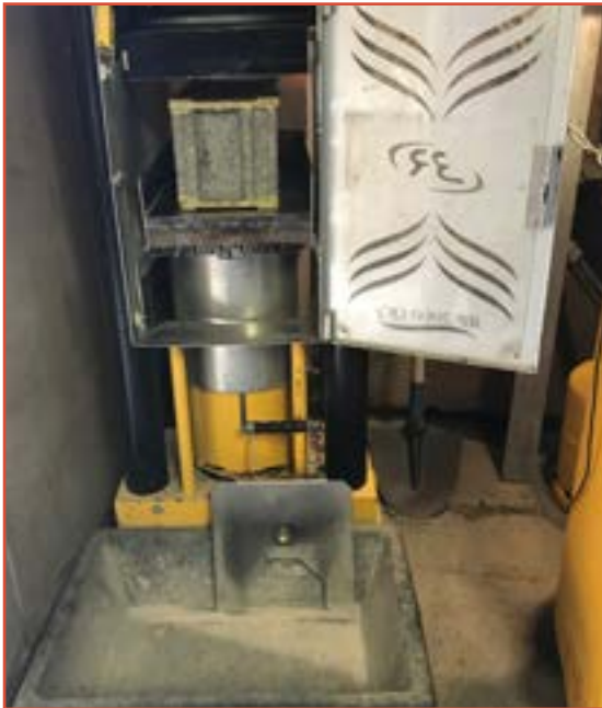
Mesure de la résistance à la compression du béton.
