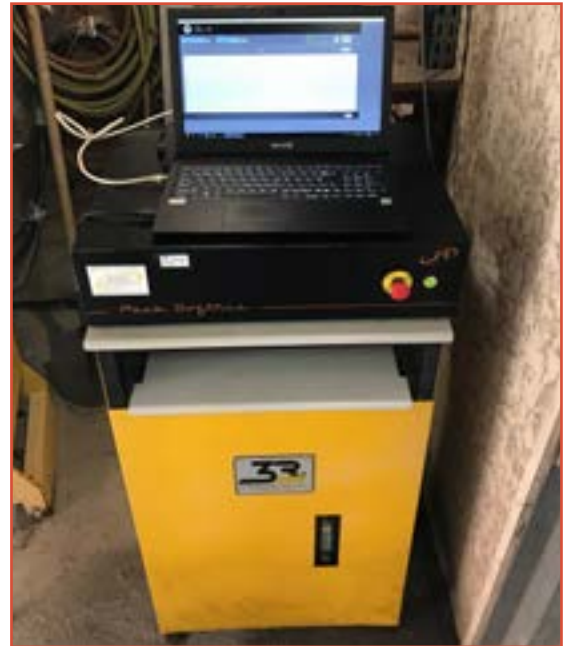
Modulation de l'application des forces et retranscription sur des courbes pour analyse.
